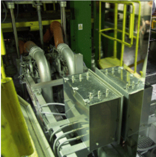
Abb. 1: eMASS im Einsatz an einer Feuerverzinkungslinie oberhalb der "air knife"
